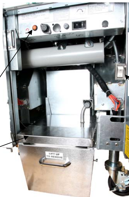
Abbildung 3: Den weißen 2-poligen Stecker befestigen und den schwarzen Stecker an die Netzdose anschließen.
